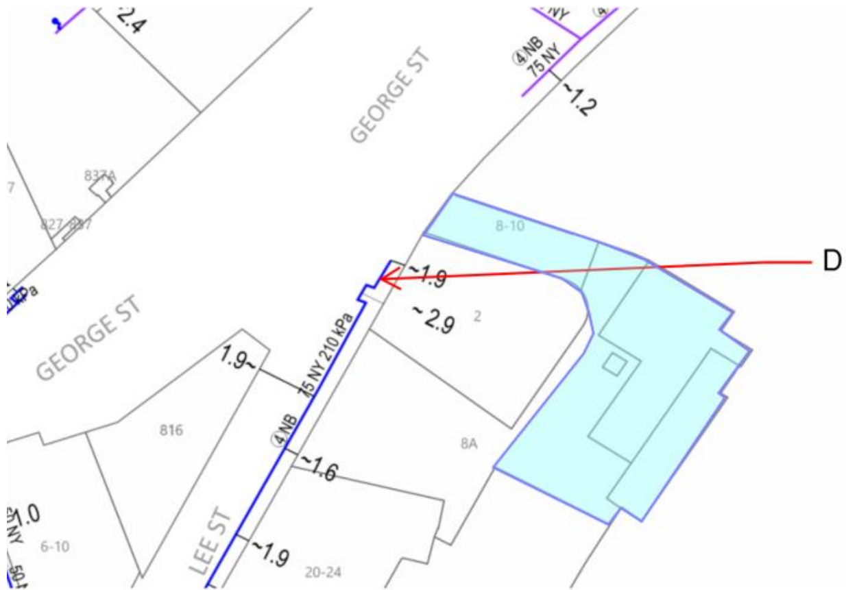
Figure 7 : Existing Jemena Gas Main (D)
